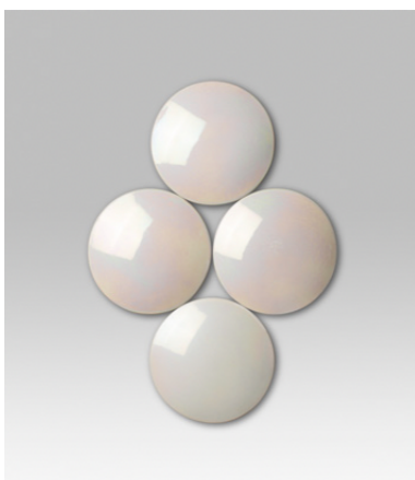
Toni Cumella Renzo Piano Projecte Centro de Arte Botín, Santander, 2017 Gres blanco, esmalte nacarado. Prensado rotativo. Cocción alta temperatura. 15,7 cm diámetro (cada elemento) Donación Ceràmica Cumella MDB, 2022
