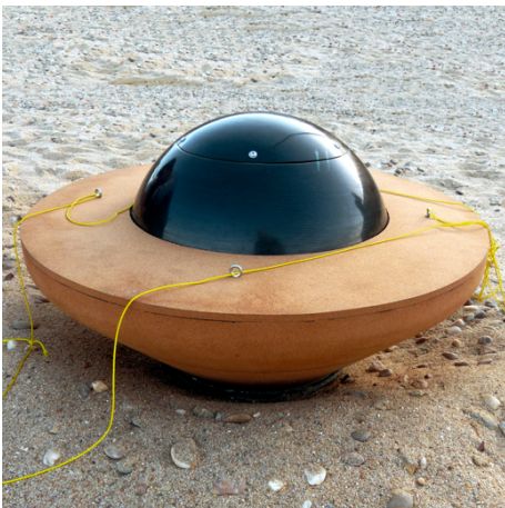
Maqueta de la càpsula de reentrada a la Terra de la missió a Mart de l'ESA, 2016. Agència Espacial Europea. Suro P50, fibra de carboni i resina epoxi. Producció: Corticeira Amorim
