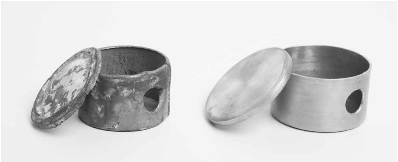
Figura 4. Un ejemplo de la reproducción de los elementos perdidos, en este caso una caja de electricidad para el tubo Bergmann, original y copia. © Xavi Padrós, 2011. Museu del Disseny de Barcelona.
