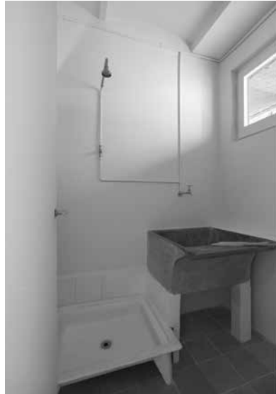
Figura 16. Fregadero y plato de ducha comparten espacio en la zona húmeda del piso, ventilada gracias a la ventana exterior. El fregadero es una pieza de cemento y el plato de ducha es de acero esmaltado al fuego, situado sobre unas patas que lo separan del suelo evitando, así, tener que empotrarlo durante la obra, lo que economizaba ese coste. © Lourdes Jansana, 2011. Museu del Disseny de Barcelona.
