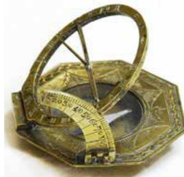
Fig. 3a.- Rellotge de sol equatorial portàtil. Ca 1800-1843
