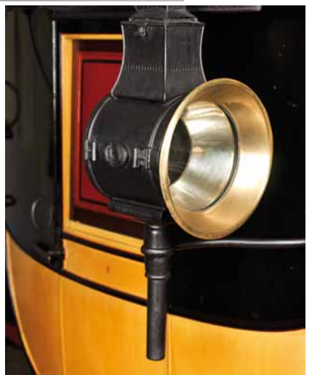
Els fanals que flanqueixen la caixa del carruatge són elements molt significatius del mail-coach, que en el seu cas facilitaven la conducció nocturna del vehicle. 2014. La Fotogràfica.
